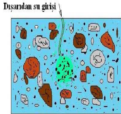
Beton içerisinde emilmiş serbest su
