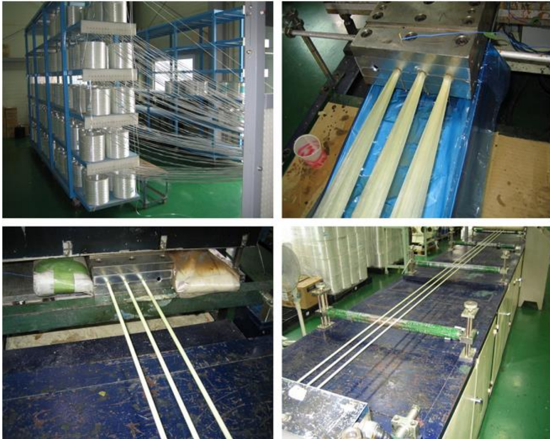
Şekil 43: FRP demiri hazırlanması için pultrüzyon proses[14]
