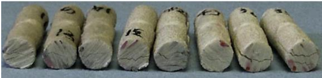
Şekil 37: Kısa çekme testinde GFRP numunelerin tipik hata modu[10]
