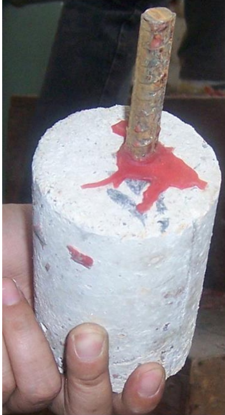
Şekil 42: İzolasyonlu daldırılmış çubuk sonunda[13]
