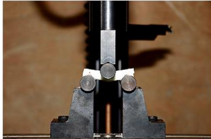
Şekil 53: Ara yüzey kayma testi mekanizması[22]
